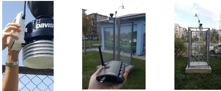
Şekil 3. 1190479 Nolu TÜBİTAK 1001 Projesi Kapsamında Kurulan “Davis Vantage Pro 2” İstasyonları
